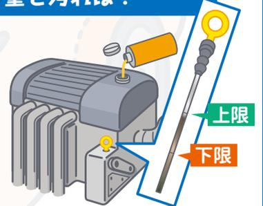
エンジンオイルを長期間交換しないで使用したり、オイルの量が目盛りの『L』(下限)より低い状態で使用を続けていると、潤滑不良でエンジン破損を招き、火災が発生することがありますので、指定のオイルを補給または交換してください。
