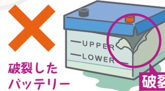
バッテリーの液面が「LOWER LEVEL」(下限)より低い状態で使用すると、バッテリーが上がったり破裂するおそれがありますので、必ず補給してください。※メンテナンスフリーバッテリーは、補給の必要がありません。
