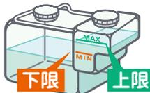
冷却水(LLC)の液面が「MIN」(下限)より低かったり、長期間交換しないで使用するとエンジンのオーバーヒートにつながるおそれがありますので、必ず補給または交換してください。
